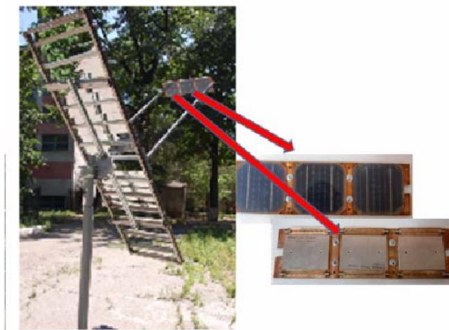
Рис. 6. Опытный образец-прототип тепло-фотоэлектрической системы с пиковой мощностью 45 Вт с тремя модулями. Справа показан вид модулей с лицевой и тыльной стороны
