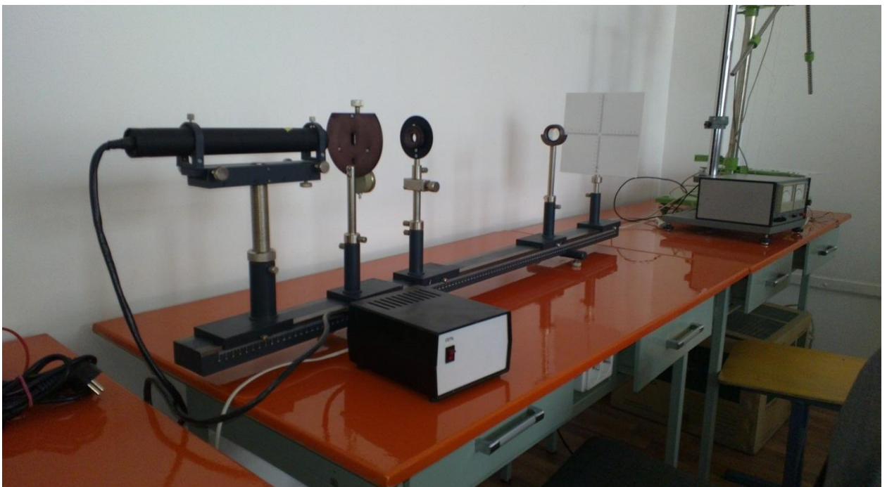
15.5-сурет. Френель бипризмасы көмегімен толқын ұзындығын анықтауға арналған құрылғы көрінісі
