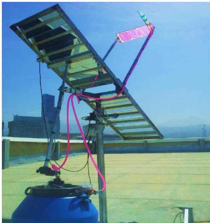
Рисунок - Проведение натуральных испытаний опытного образца концентраторного монолитного трехэлементного тепло-фотоэлектрического преобразователя солнечной энергии, проводилось в июле-сентябре 2016 года на крыше физико-технического факультета КазНУ им. аль-Фараби
