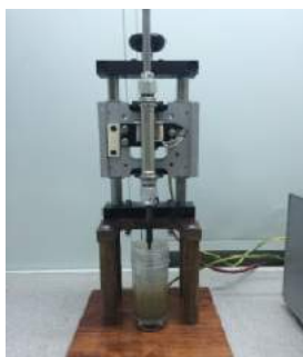
Рисунок 1. Электродуговая установка в жидкой фазе и ее структурная схема - 1 – сосуд реакционной зоны, 2 – рабочая жидкостная среда, 3 – источник переменного тока
