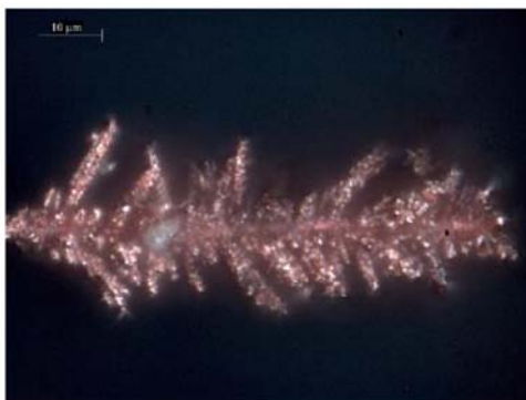
Рис.3. Микрофотография порошка меди полученного в ультразвуковой ванне с катодом покрытой фильтровальной бумагой
