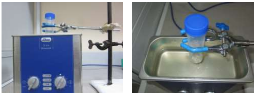
6.5-сурет. Ультрадыбысты ваннаның көрінісі
