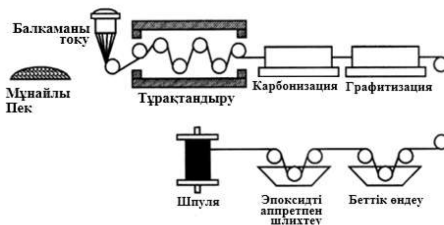
3.24-Сурет. Өрілген талшықтан жасалған көміртек талшықтары өнімінің сызбасы [19]
