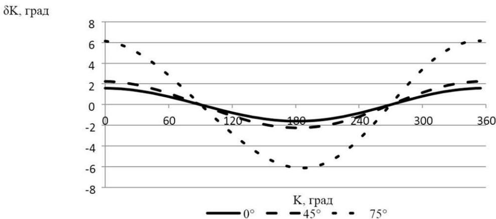
Рис.2. Скоростные погрешности  $\delta k$  для различных широт.
