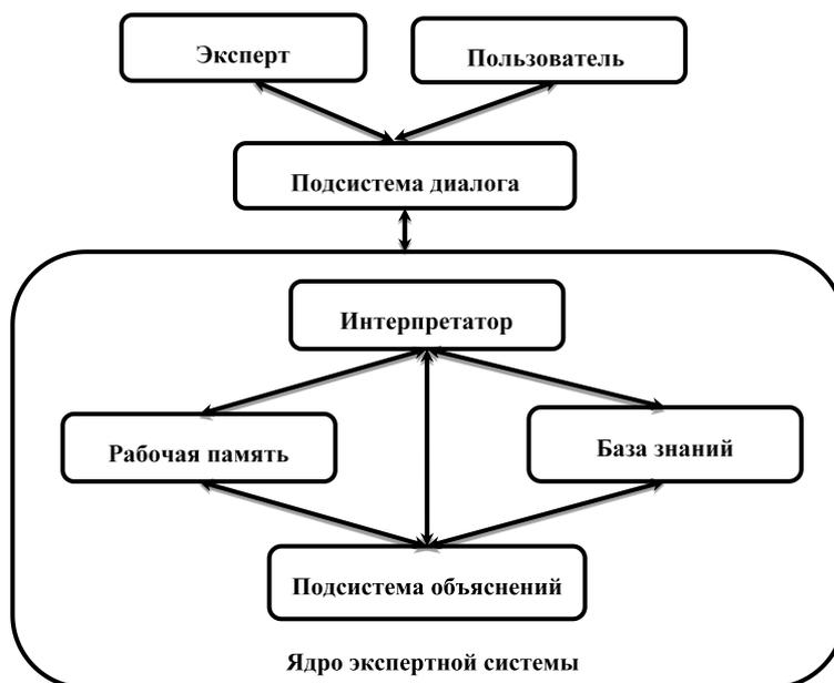
Рис. 2. Структура экспертной системы проектирования строительства подземного строительства.
