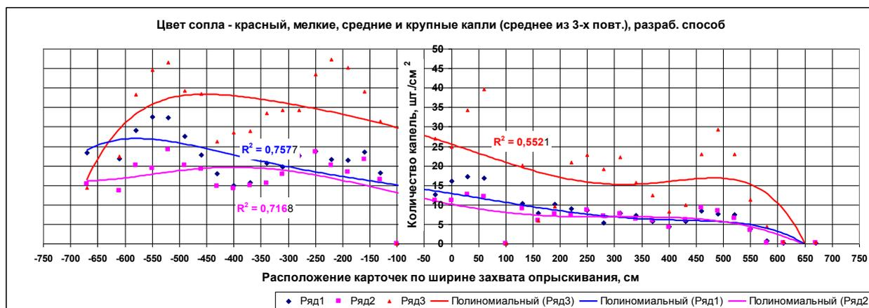
Рисунок 3. Густота покрытия капель/см<sup>2</sup>, усредненных трехкратной повторностью по ширине захвата при разработанном способе опрыскивания соплами LU – 04 AD – 04 (код цвета – красный)
