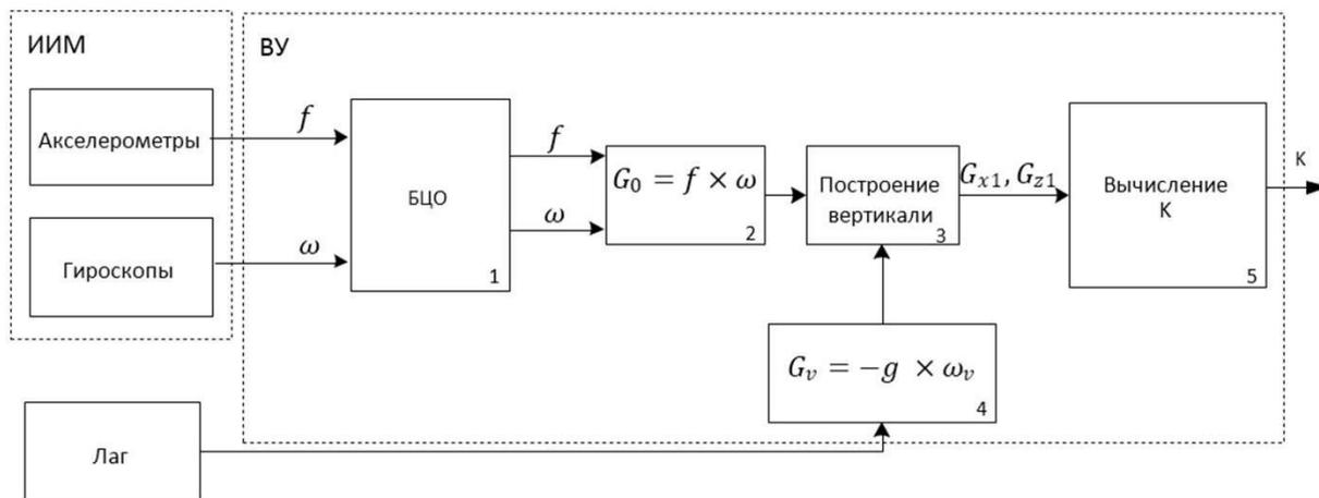
Рис. 3. Структурная схема БГК с использованием показаний лага.
