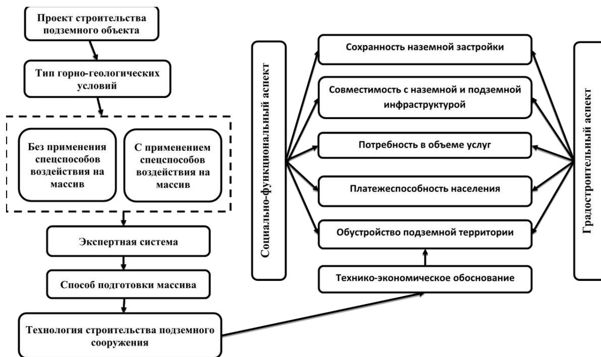
Рис. 1. Блок-схема проектирования подземного сооружения
