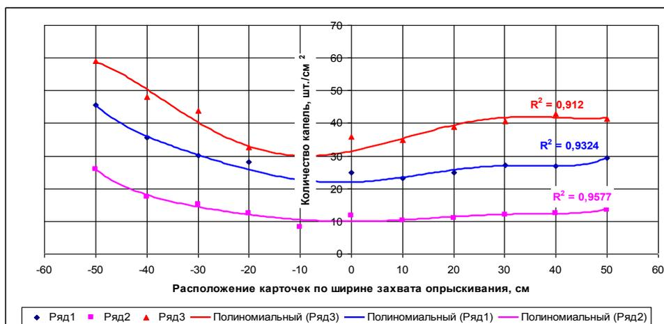
Рисунок 4. Густота покрытия капель/см<sup>2</sup>, усредненных трехкратной повторностью, по ширине захвата при традиционном способе опрыскивания соплами LU – 04 AD – 04 (код цвета – красный)
