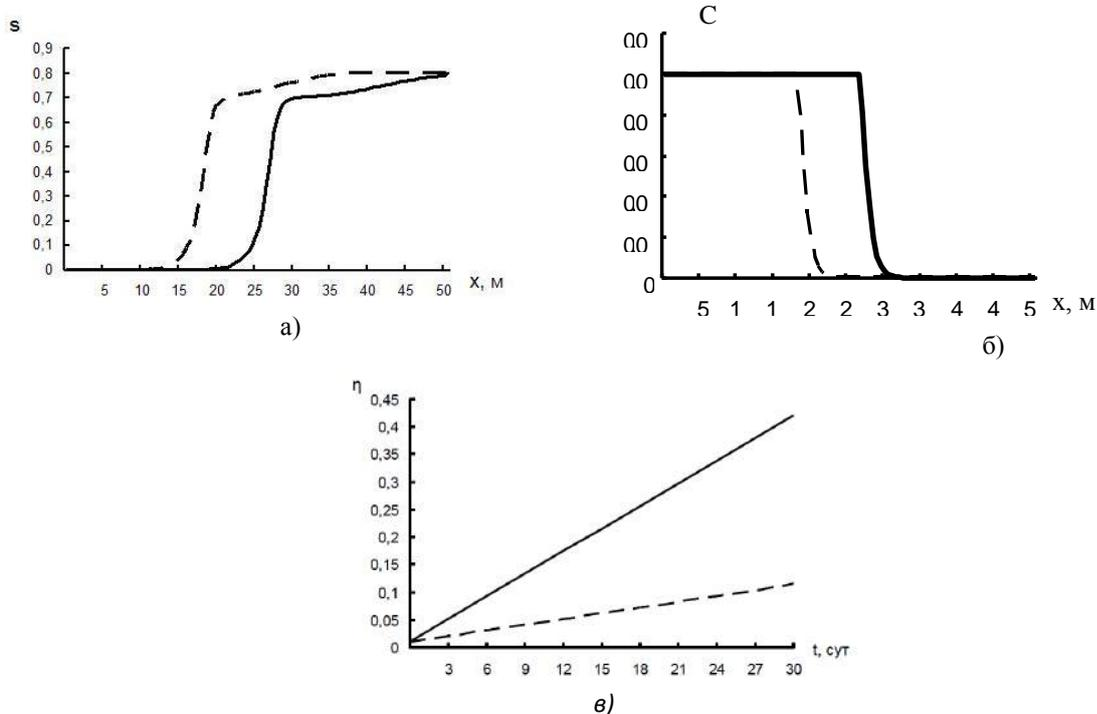
Рисунок 1. Влияние дисперсного состояния жидкостей на: нефтенасыщенность, а); концентрацию ПАВ, б); на коэффициент нефтеотдачи, в);  $t=30$  сут; сплошная линия соответствует заводнению с ПАВ без учета дисперсного состояния жидкостей, пунктирная с учетом дисперсного состояния.
