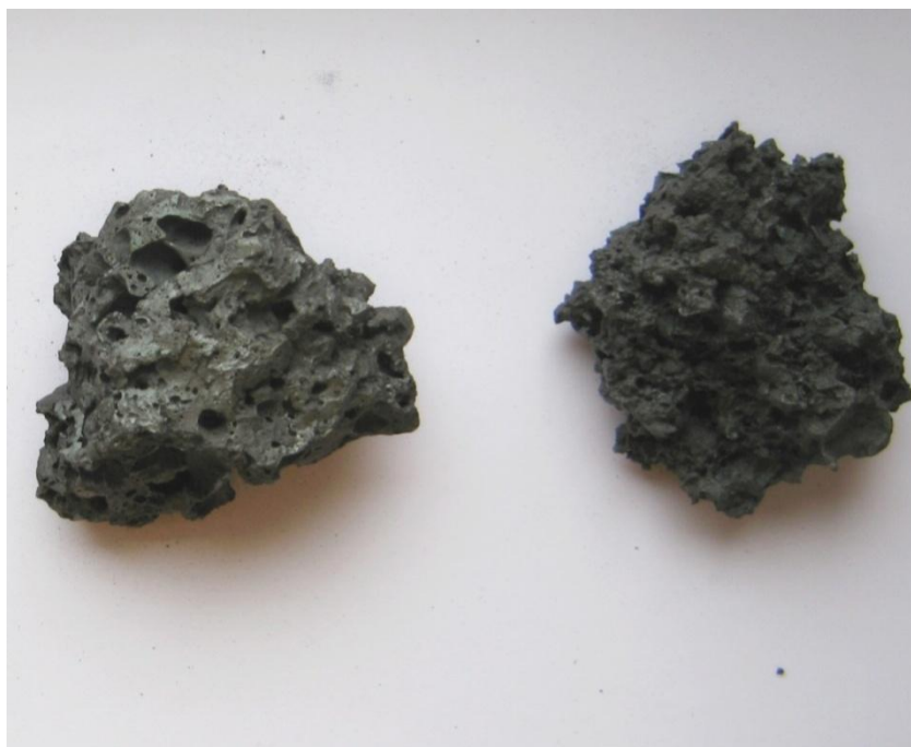
Рис. 5. Слева - спек агломерата с ИПС-ТФ, справа –спек агломерата при базовом варианте.
