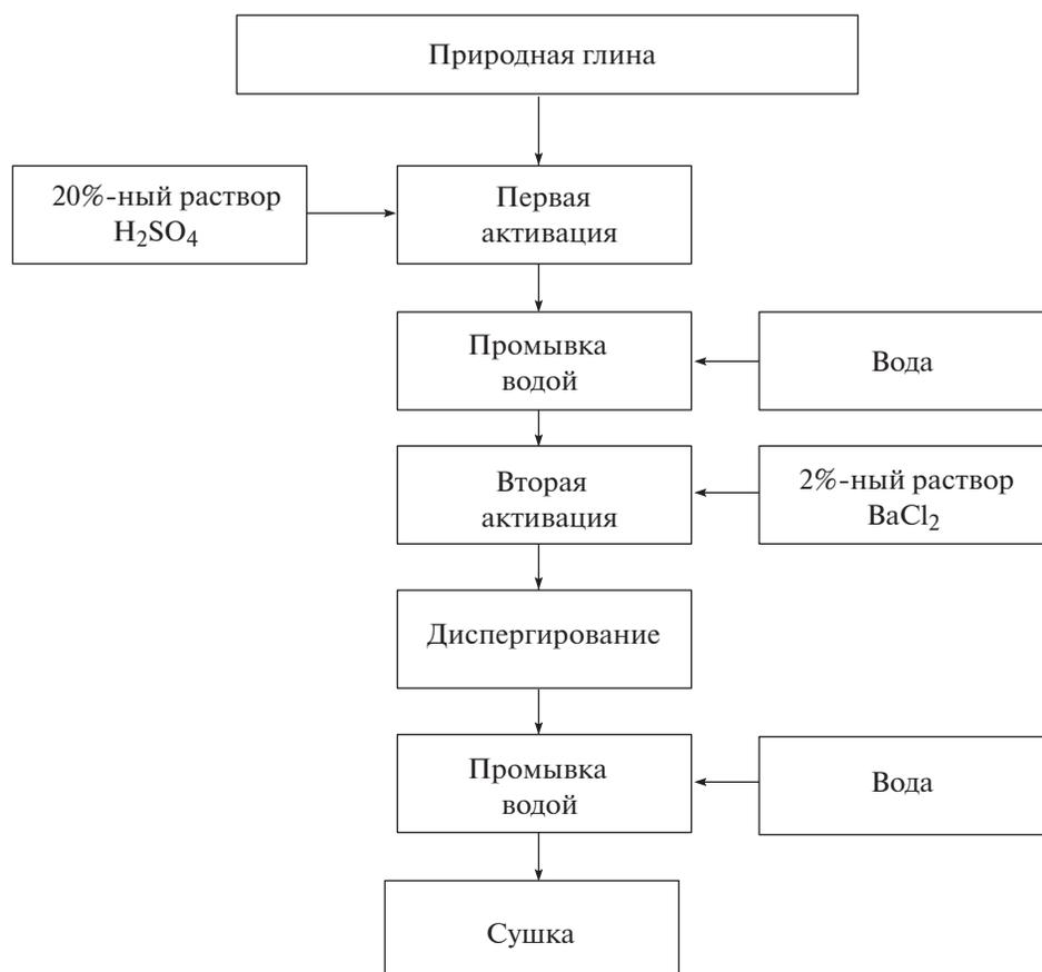
**Рис. 1.** Схема синтеза суспендированного катализатора крекинга.
