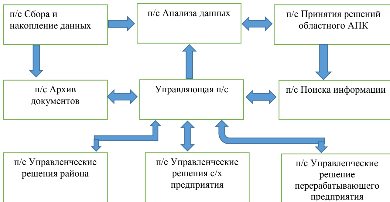
Рис. 2. Функциональная структура ИС для поддержки управленческих решений областного АПК
