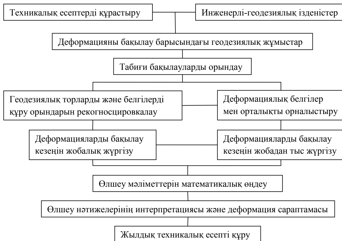
3 Сурет – Құрылыс пен ғимараттардың деформациясын бақылауының кешендік жұмыстарының жалпы сызбасы [1]
