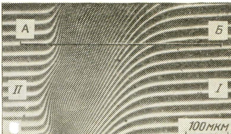
Рисунок 1 – Пример типичной интерферограммы, получаемой при контакте полимера с низкомолекулярным растворителем. АБ – линия равной толщины. Г – низкомолекулярный растворитель, Д – полимер. Каждая полоса на фотографии – геометрическое место точек, для которых оптическая плотность клина одинакова
