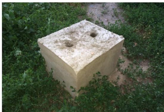
Рисунок 3 – Железобетонная колонна с 2-мя шпурами для ввода газогенератора работающего в режиме дефлаграционного горения
