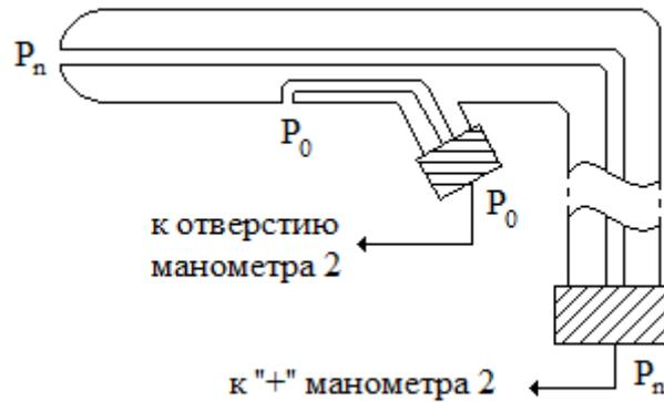
Рис. 9. Схема подсоединения трубки Прандтля к микроманометру
