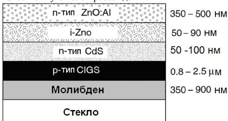
Рисунок 2. Схема каскадного тонкопленочного солнечного элемента на базе полупроводниковых пленок \text{CdS/CuInGaSe}_2
