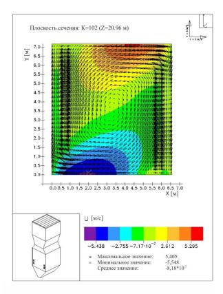
Рис.1. Распределение u-компоненты вектора полной скорости в поперечном сечении нижнего яруса камеры сгорания (h=4.81 м)
