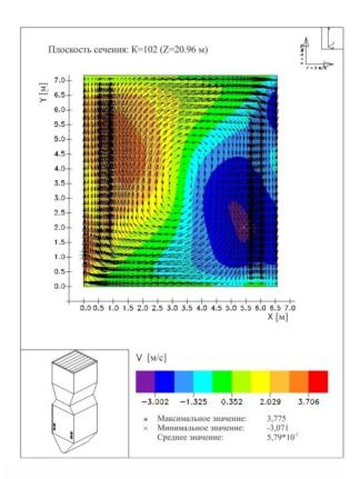
Рис.3. Распределение v-компоненты вектора полной скорости в поперечном сечении нижнего яруса камеры сгорания (h=4.81 м)
