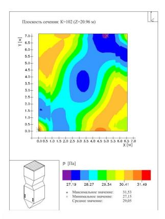
Рис.7. Распределение давления P в поперечном сечении камеры сгорания в зоне горелок (h=4.81 м)
