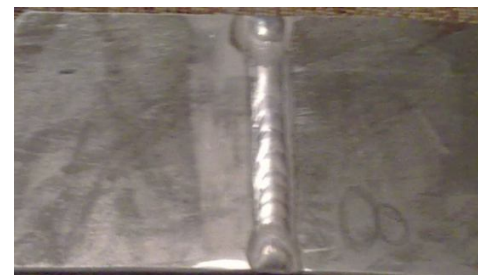
Рисунок 1 – Загальний вид зварного шва заготовок зі сплаву 01570
