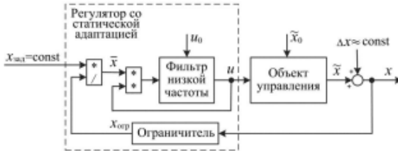
Рисунок 2. Структурная схема предлагаемой стабилизирующей системы управления.
