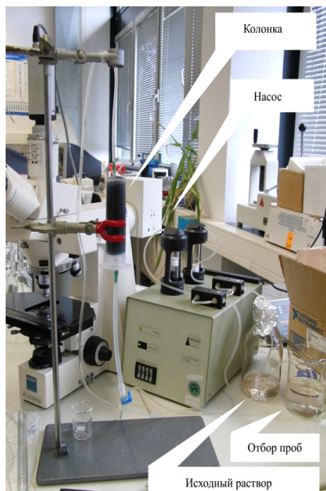
Рисунок 3 – Экспериментальная установка для изучения процесса связывания ЛПС с КРШ в непрерывном режиме (в колонке)
