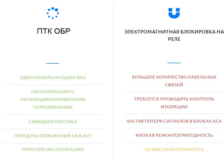
Рисунок 3 – Сравнение предлагаемой и традиционной видов блокировок
