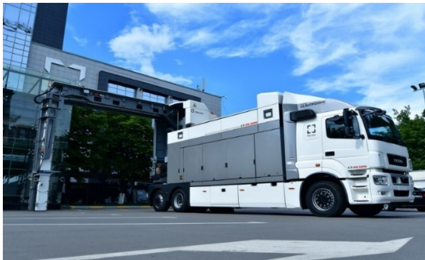
Рисунок 1 – Отечественный мобильный инспекционно-досмотровый комплекс нового поколения на базе автомобиля КАМАЗ
