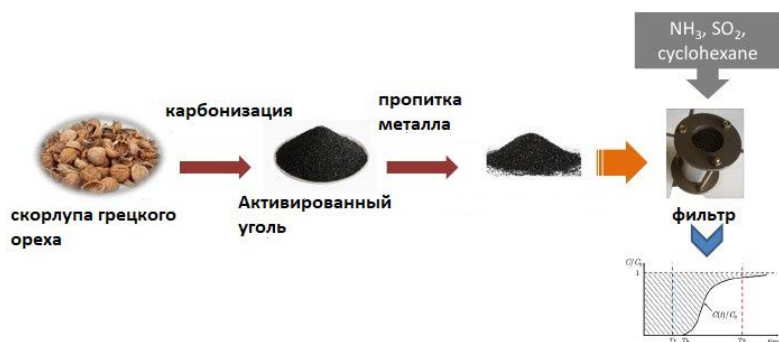
Рисунок 6.17: Переработка отходов биомассы в высокоэффективные реакционно-способные сорбенты для борьбы с выбросами токсичных газов
