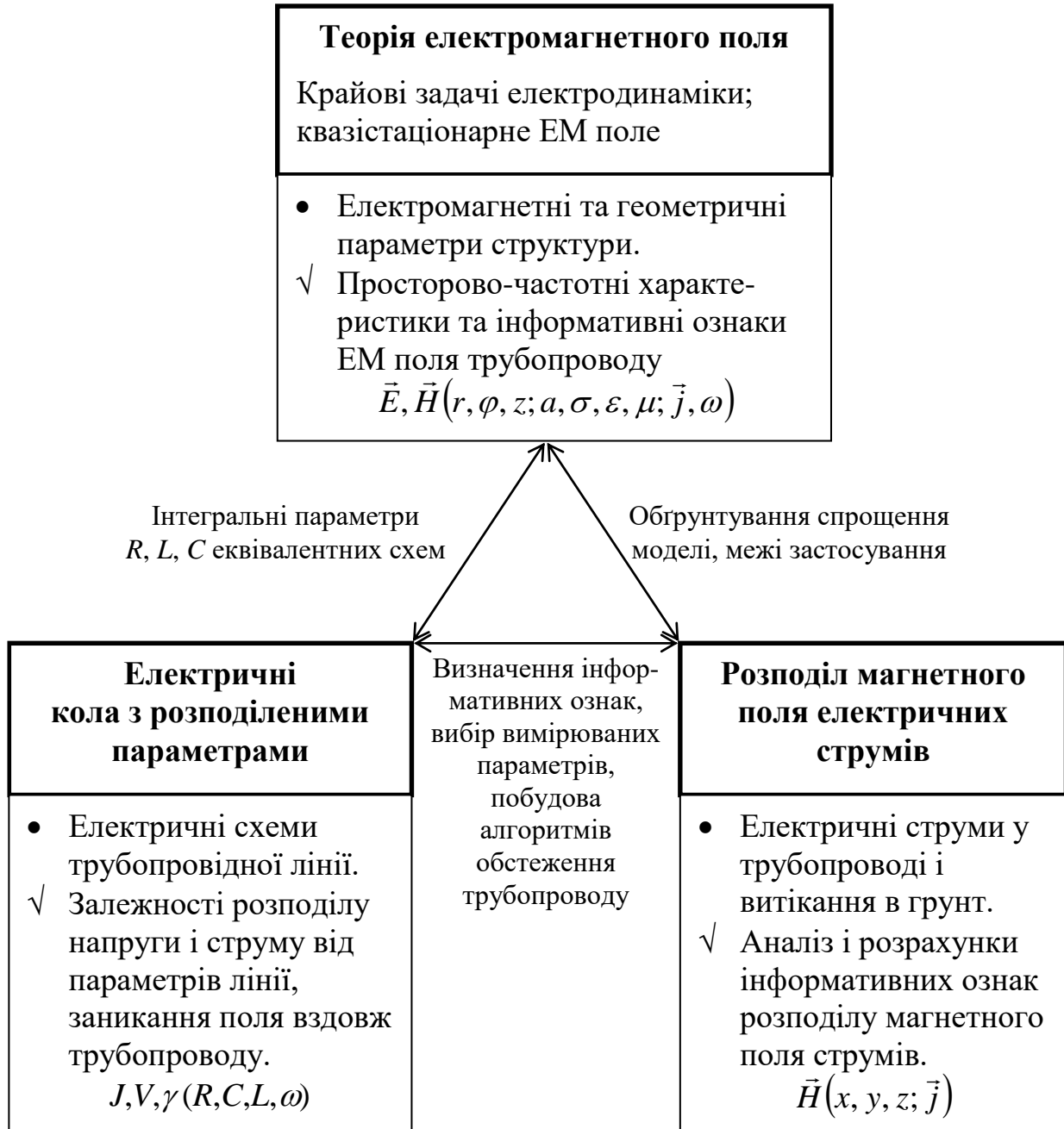
Рис. 1. Структура триєдиної математичної моделі (ТЕММ) електромагнітного (ЕМ) поля підземного трубопроводу (ПТ).
