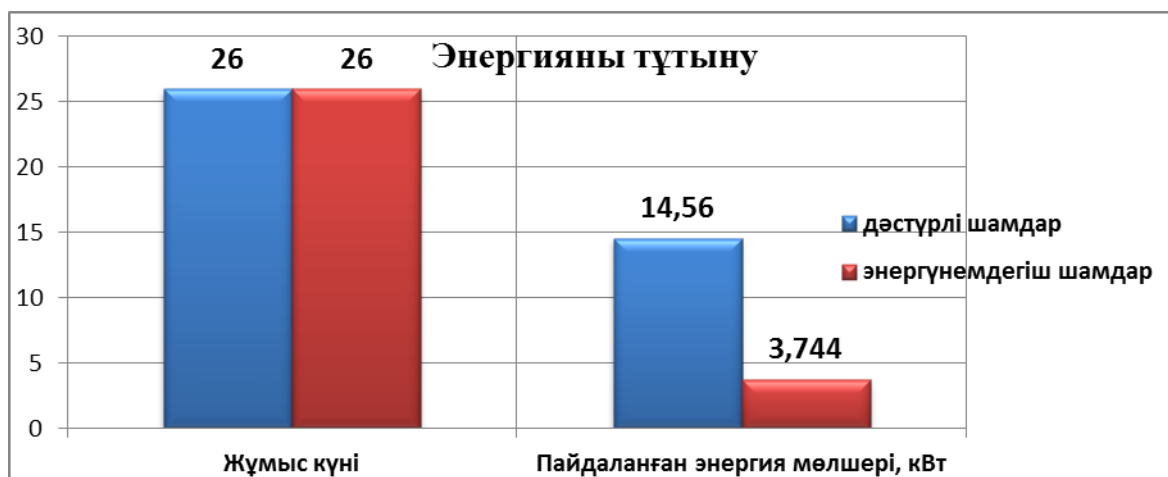
3-сурет. Дәстүрлі шам мен энергоүнемдегіш шамдардың энергия пайдалану қуатын салыстыру.
