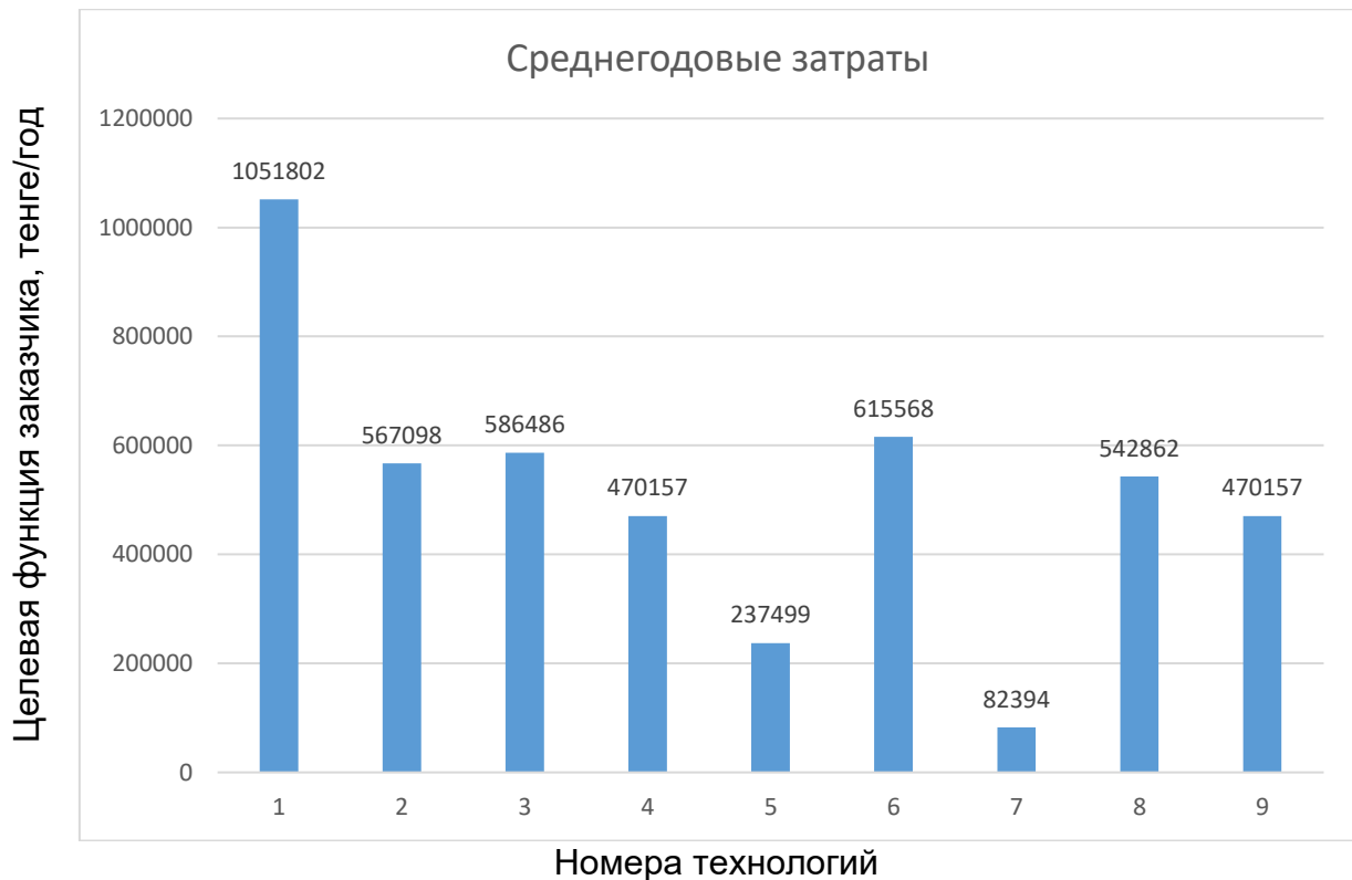
Рис. 1. Критерии среднегодовых затрат заказчика на строительно-монтажные работы при учете уменьшения среднегодовых эксплуатационных затрат по имеющимся технологиям для сооружения общей площадью 10479 м 2 , высоту 6,5 метров
