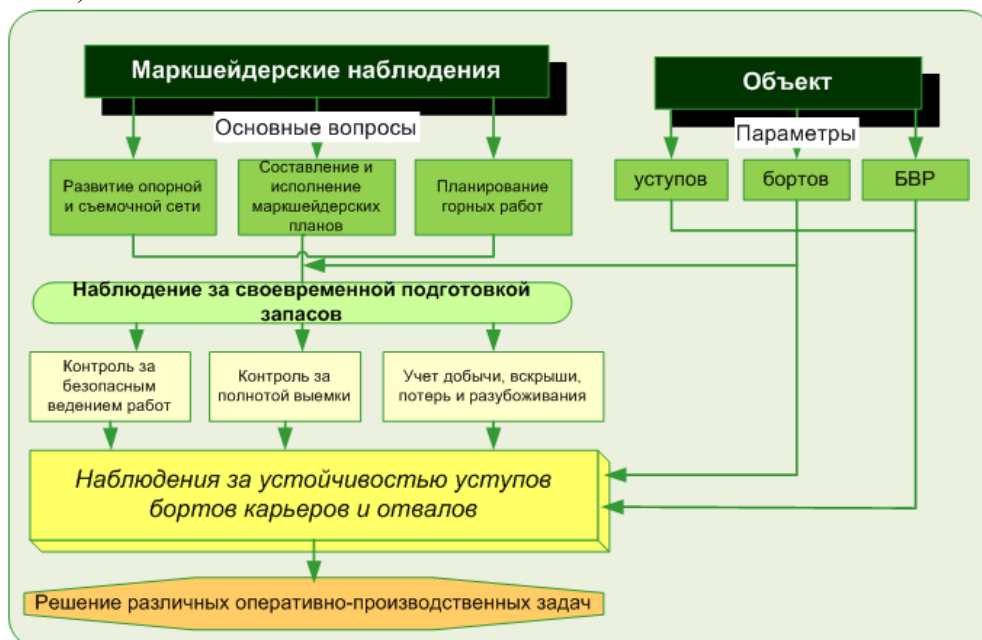
Рисунок 1-Схема основных маркшейдерско-геодезических работ на карьерах
