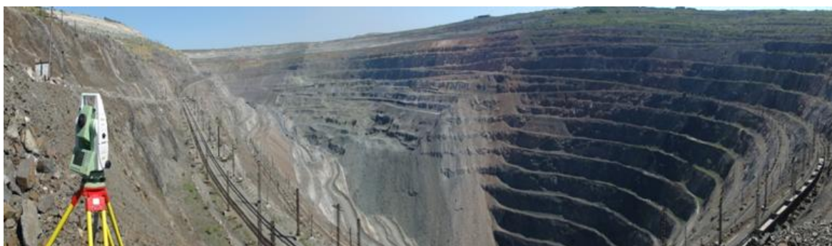
Рисунок 2 – Инструментальный контроль состояния западного борта Соколовского карьера с использованием роботизированного электронного тахеометра ТСА1202
