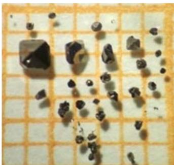
Рис. 1 Фотография монокристаллов  $NbAs_{0.75}P_{0.25}$ . Длина одной клетки 1 мм.
