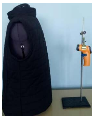
Рисунок 2 - Определение температуры с помощью пирометра VICTOR DT-812 в климатической камере.
