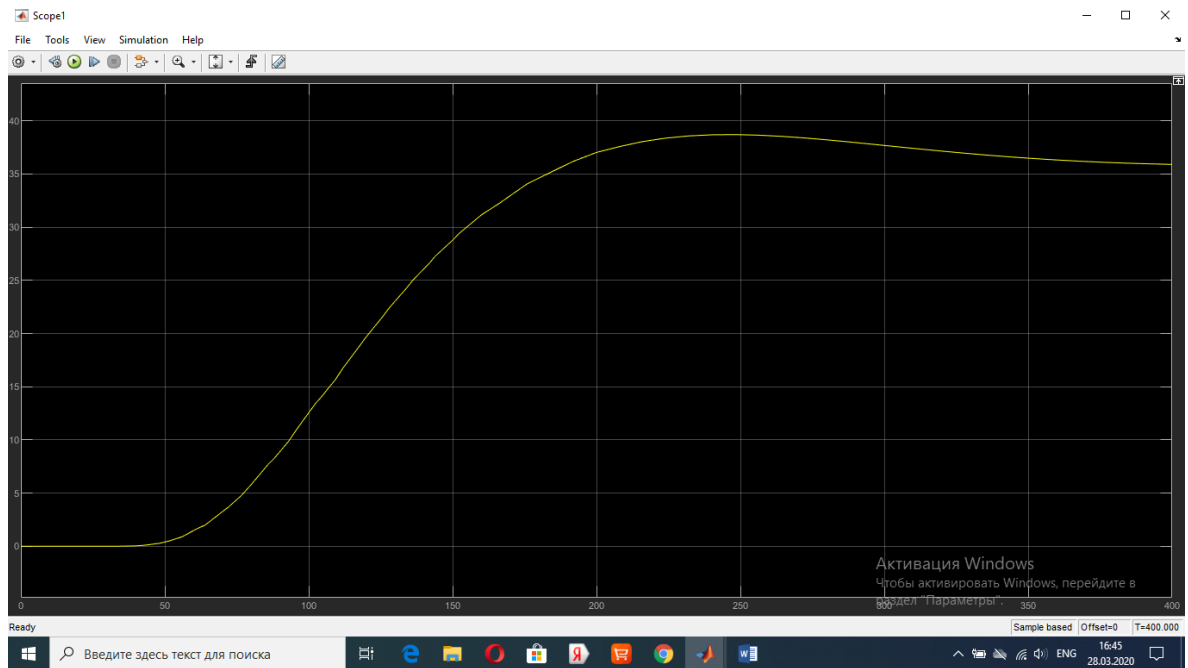
4-Сурет. MatLab «Simulink Control Design» бағдарламасында жасалған ПИД-реттегіш жұмысының графикалық кескіні.
