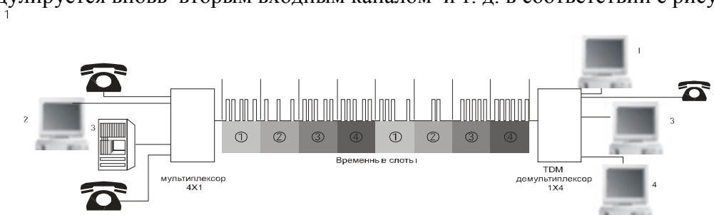
Рисунок 1 – Принцип передачи информационных каналов в системах TDM технологий
