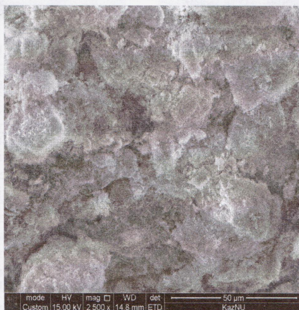
Сурет 4. Таған кенорнының монтмориллонитінің құрылымының СЭМ фотографиясы
