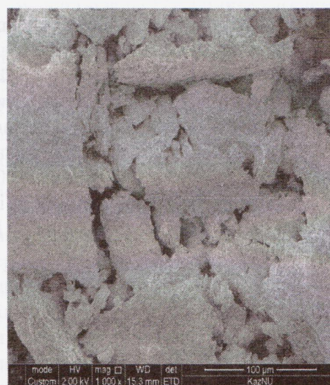
Сурет 6. Таған бентонитіндегі ЦПБ-ның адсорбциясынан кейінгі құрылымының СЭМ фотографиясы
