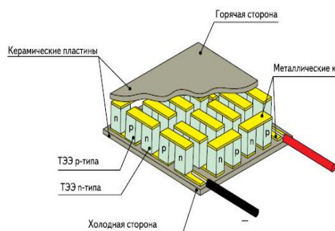
Рис. 4. Модуль охлаждения детекторной структуры на основе элемента Пельтье.
