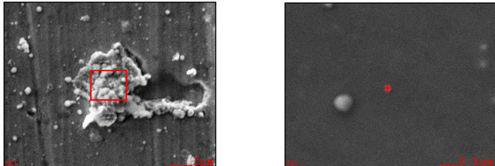
Осажденные частицы меди при давлении в камере  $10^{-2} - 10^{-3}$  мбар
