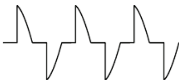
Рис.2. Типовая форма сигнала в нелинейной нагрузке
