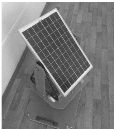
Рис. 3. Дизайн механической части солнечного трекера.
