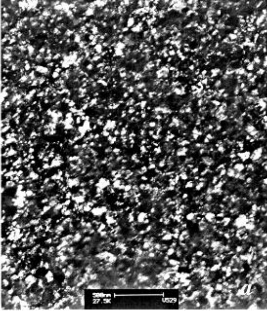
Рисунок 58. Морфология поверхности тонкой пленки SnO_2 . (a) – эксперимент; (b) – теория:
