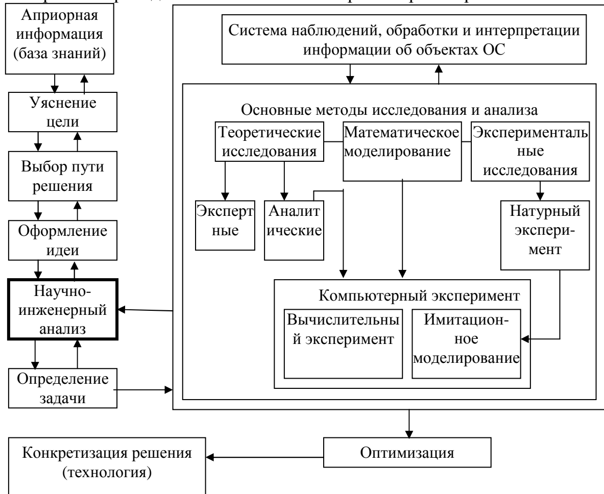
Рис. 11. Блок-схема процесса инженерно-исследовательского проектирования
