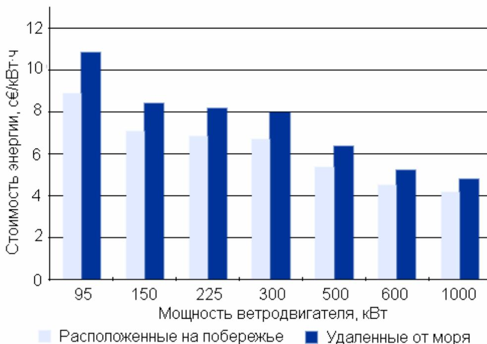
Рис. 6.2.3. Зависимость стоимости электроэнергии от мощности ветродвигателей при их расположении на побережье и вдали от моря
