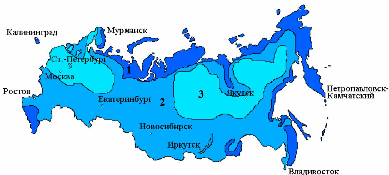
Рис. 6.1.2. Карта ветроэнергетических ресурсов России. Цифрами обозначены зоны со среднегодовыми скоростями ветра: 1 – выше 6 м/сек; 2 – от 3,5 до 6 м/сек; 3 – до 3,5 м/сек.
