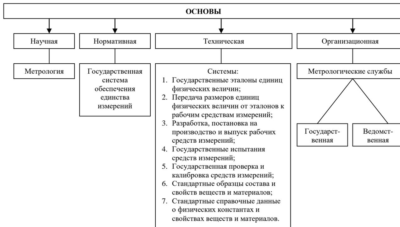
Схема 3.3 – Основы метрологического обеспечения
