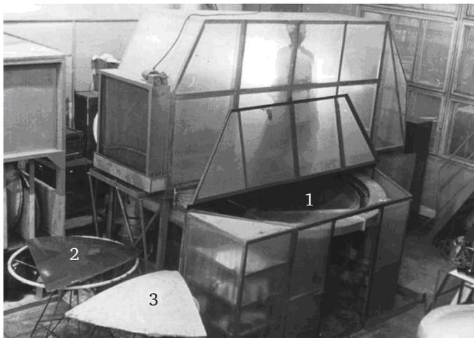
**Рис. 1.7. Экспериментальная установка для отливки параболоидных матриц-оригиналов диаметром до 2,5 м:**
