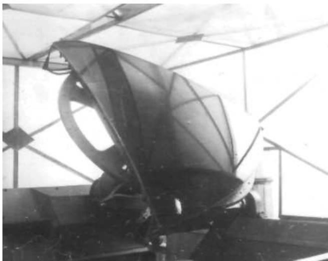
**Рис. 1.12. Секторная отливка матрицы-оригинала для концентратора  $\varnothing$  2,5 м на установке для изготовления гальванокопий**
