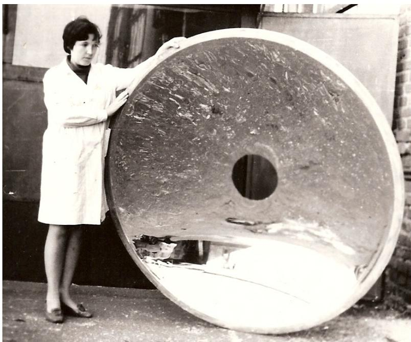
**Рис. 1.14. Гальванокопия, созданная по отлитой из эпоксидной смолы матрице-оригиналу  $\varnothing$  1,5 м ( по краям концентратора выполнена отбортовка для крепления обода жесткости)**
