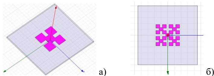
Рисунок 2. Компьютерная модель фрактальной антенны на основе квадрата Серпинского (2-ая а) и 3-я б) итерации)
