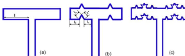
Рисунок 1. Модель фрактальной антенны на основе кривой Коха нулевой (а), первой (b) и второй (c) итераций
