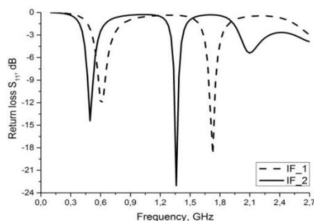
Рисунок 10. Частотная зависимость коэффициентов отражения антенны Минковского
