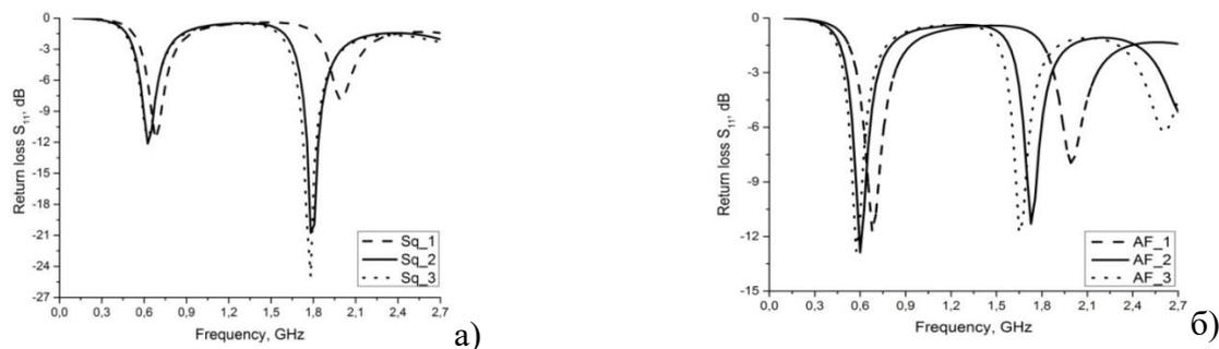
Рисунок 9. Частотные зависимости входных коэффициентов отражения фрактальной антенны Коха (а) и антенны Жанабаева (б)
