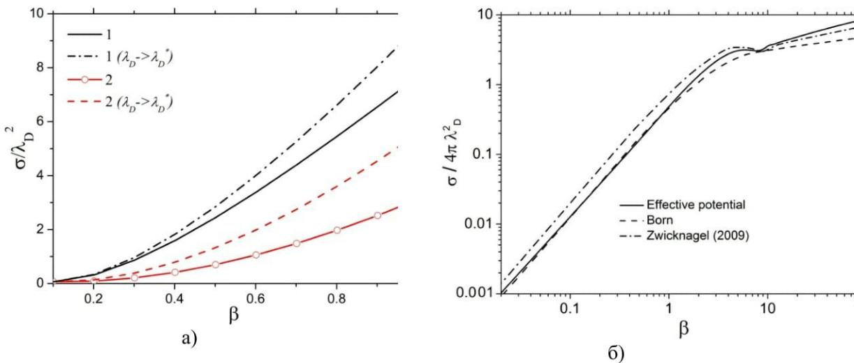
Рисунок 5 – а) Сечения рассеяния при  $\Gamma = (\beta/Z_{ion})^{2/3} 6^{-1/3}$  и  $d = 0.4$ , полученные: 1 - на основе потенциала Юкавы; 2 - на основе эффективного потенциала (5).
