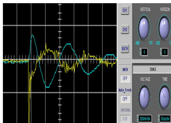
Сурет 2. Кернеуі U=3\text{ кВ} , арақашықтығы L=10\text{ см} болатын қос роговский белдігінен алынған осциллограмма
