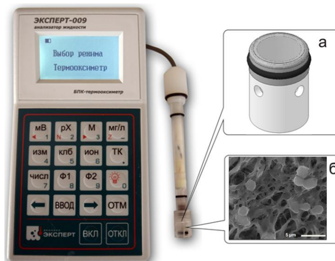
Рис. Внешний вид БПК-термооксиметра «Эксперт-009» с амперометрическим датчиком ДКТП-02.06: а – фиксатор биорецепторного элемента, б – микрофотография дрожжевых клеток Debaryomyces hansenii ВКМ У-2482 иммобилизованных в гидрогель модифицированного поливинилового спирта
