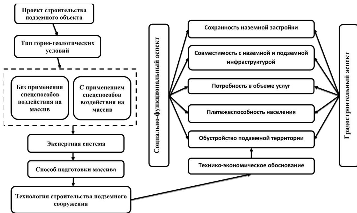
Рис. 1. Блок-схема проектирования подземного сооружения
