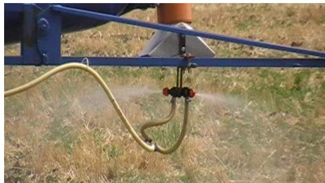
Рисунок 2. Фрагмент рабочего процесса пневмогидравлического устройства нанесения раствора пестицида на растения щелевыми распылителями пневмогидравлического устройства экспериментального образца опрыскивателя при проведении лабораторно – полевых исследований
