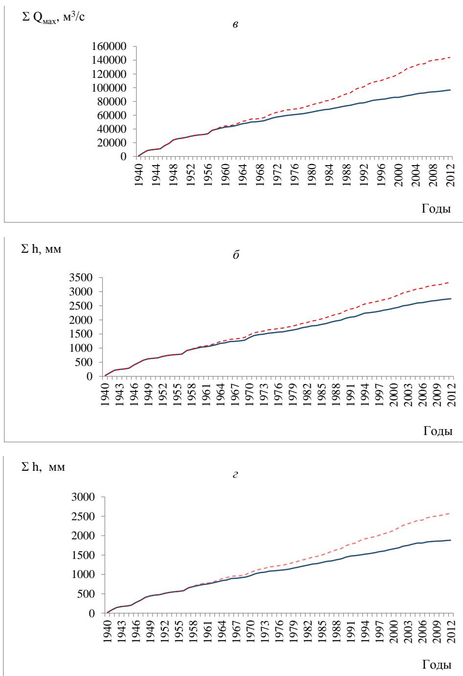
Рисунок 1 – Суммарные интегральные кривые максимальных расходов воды ( $Q_{\max}$ ,  $\text{м}^3/\text{s}$ ) и слоя весеннего стока ( $h$ ,  $\text{мм}$ ): а, б - р. Жайык – с. Кушум; в, г – р. Жайык – с. Махамбет. Условные обозначения: - - - – условно-естественные значения максимального и слоя весеннего стока; — – фактические значения максимального стока и слоя весеннего стока.
