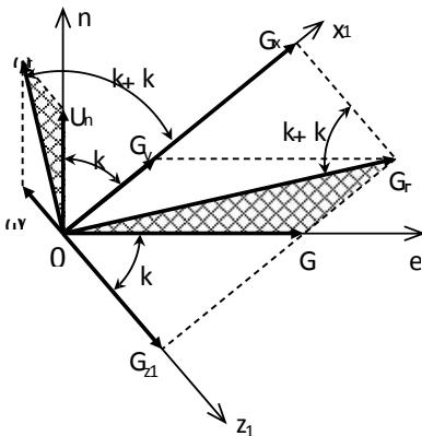
Рис.1. Схема навигационных треугольников угловых скоростей первой четверти плоскости горизонта One.
