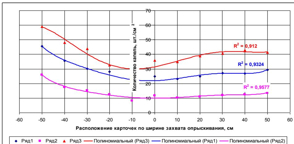
Рисунок 4. Густота покрытия капель/см<sup>2</sup>, усредненных трехкратной повторностью, по ширине захвата при традиционной способе опрыскивания соплами LU – 04 AD – 04 (код цвета – красный)
