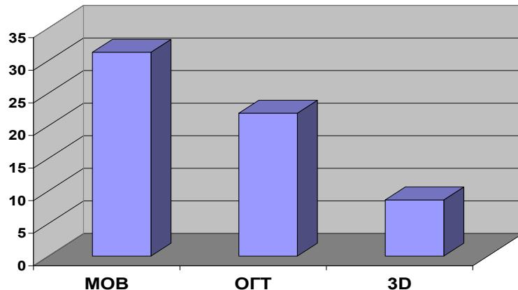
Рисунок 2. Величина среднеквадратической апостериорной погрешности структурных построений для различных модификаций сейсморазведки в пределах Саратовской области за период 1965 - 2008 г.г.
