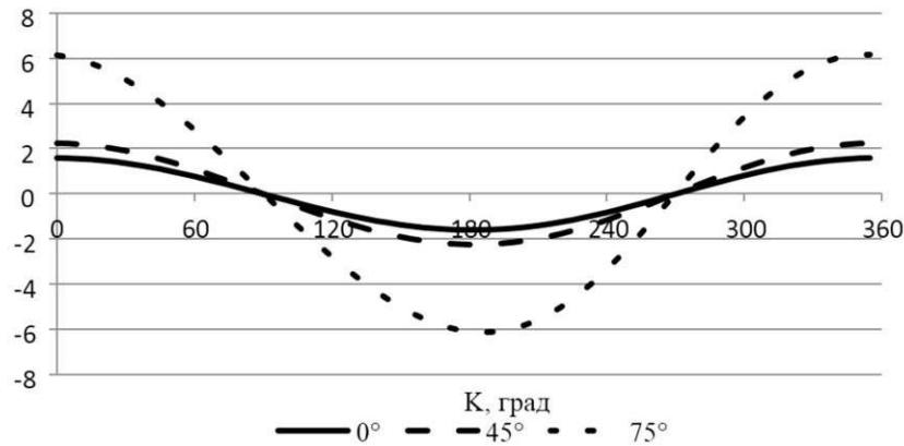
Рис.2. Скоростные погрешности δK для различных широт.
