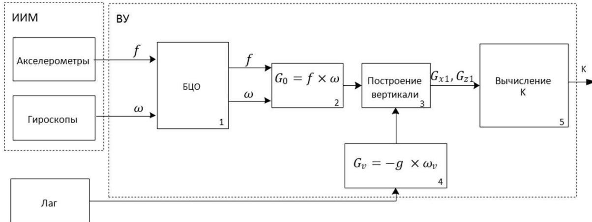
Рис. 3. Структурная схема БГК с использованием показаний лага.
