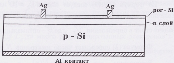
Рисунок 1 - Конструкция солнечного элемента с пористым кремнием
