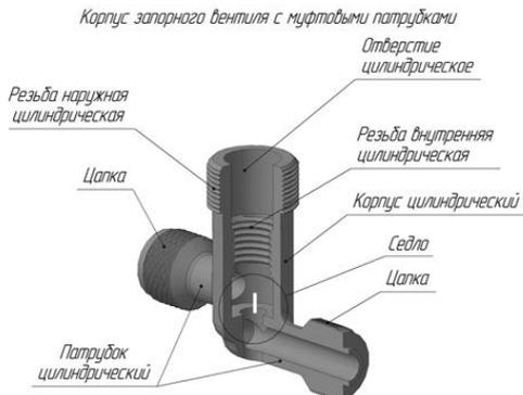
Рисунок 1. Конструктивные элементы структуры детали
