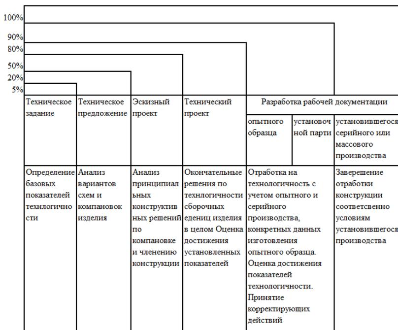
**Рисунок 1. Отработка конструкции на технологичность**
