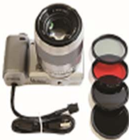
Рисунок 1 - Мультиспектральная фотокамера на базе фотоаппарата Sony-Alpha A5000(NIR). Спектральный диапазон 400 - 1000 н.м.
