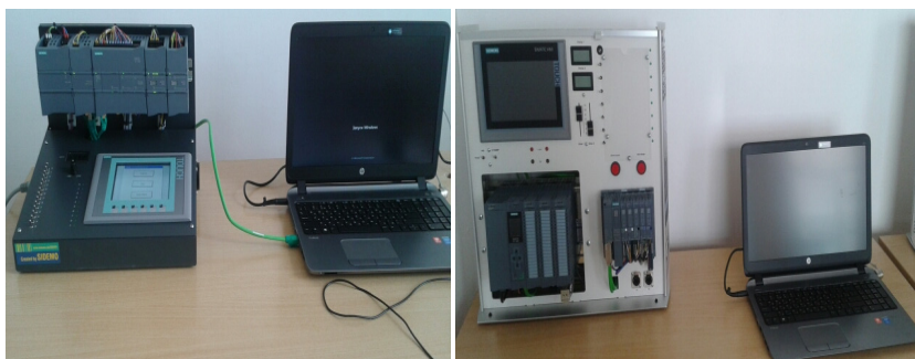
Рисунок 1 – Лабораторные стенды фирмы SIEMENS на базе SIMATIC S7-1200 с HMI , SIMATIC S7-1500 с HMI, и SCADA-системы на базе WinCC
