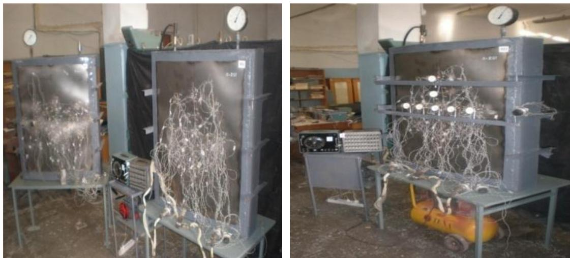
Рисунок 1- Общий вид модели фрагмента стенки резервуара с вмятинами
