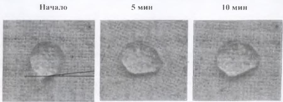
Рис. 8 – Капля воды на ткани обработанной методом Обручева [7]
