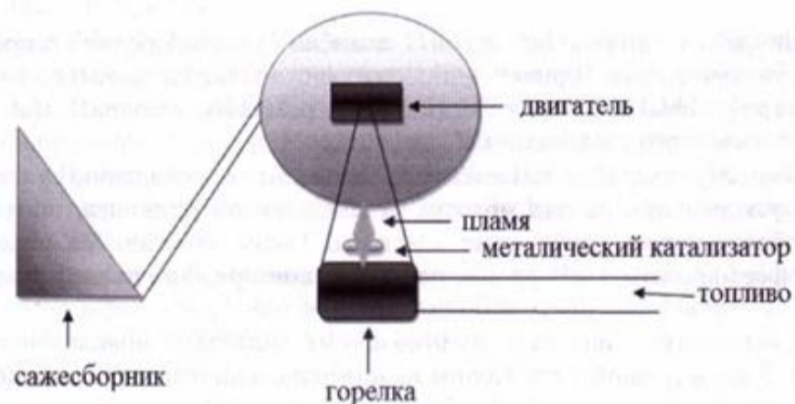
Рисунок 2 – Схематическое изображение установки для исследования влияния никелевого катализатора на сажеобразование
