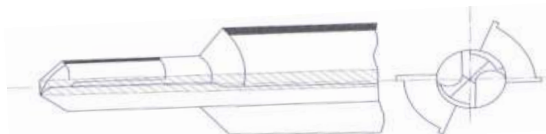
2-rasm. Parmaning kichraytirilgan ishchi qismida lentachalar sonini 4 tagacha ko'paytirish.
