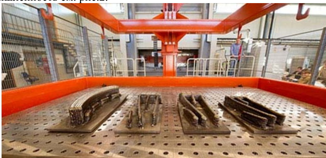
Рисунок 2 - DMD производство титановых компонентов.
